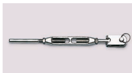
Tenditori acc. inox con canaula aperta - forcella a snodo incorporato e terminale cilindrico a pressare. Rigging screws open body and integral toggle - swaging terminal.
