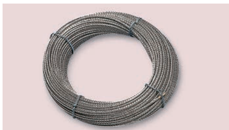
Cavo inox AISI 316 spiroidale a 19 fili (1+6+12). Matasse da 100 mt
