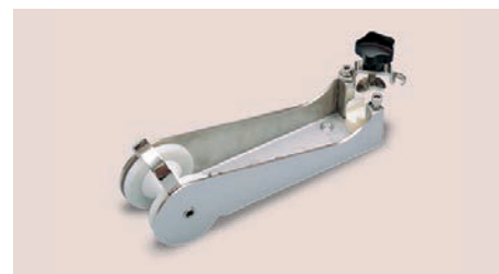
Musone in acciaio inox AISI 316 lucidati a specchio lungh. 330 largh. 80 sp. 4 mm con 1 bloccaggio. Per ancore Bruce/ Danforth fino a 10 Kg Cod. 229.06 Polished stainless steel AISI 316 bow roller length 330 width 80 thickness 4 mm with bloking device. For anchors Bruce/ Danforth up to 10 Kg Cod. 229.06
