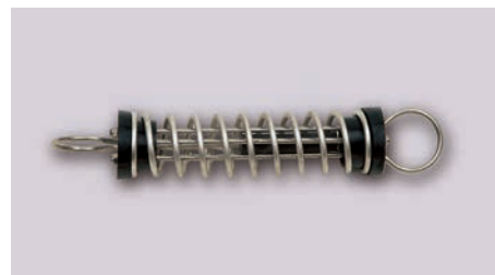
Molle silenziose in acciaio inox Stainless steel anchor line absorber. provviste di fine corsa antisnervamento e le particolari teste consentono una perfetta assialità durante la compressione.
