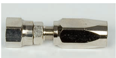
AC10/T916 Filetto 9/16-24 UNF / per Tubo 1/4
